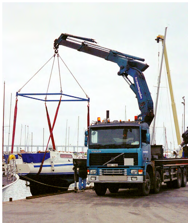
Bild 3:4 Lastbil med kraftig kran och lyftok. Även här gäller att ha stödbenen utfällda och att säkra slingan.
