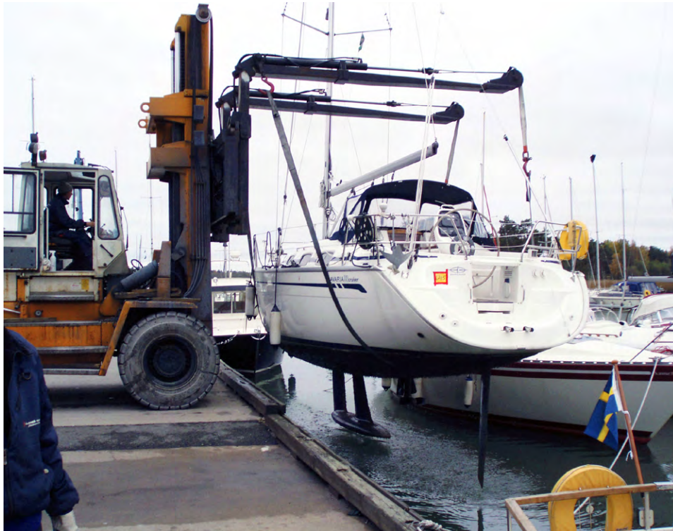
Bild 3:2 Gaffeltruck där man lyfter båten direkt i vaggan. OBS! Båten kan lyftas med masten kvar. Notera stoppet vid kajkanten.
