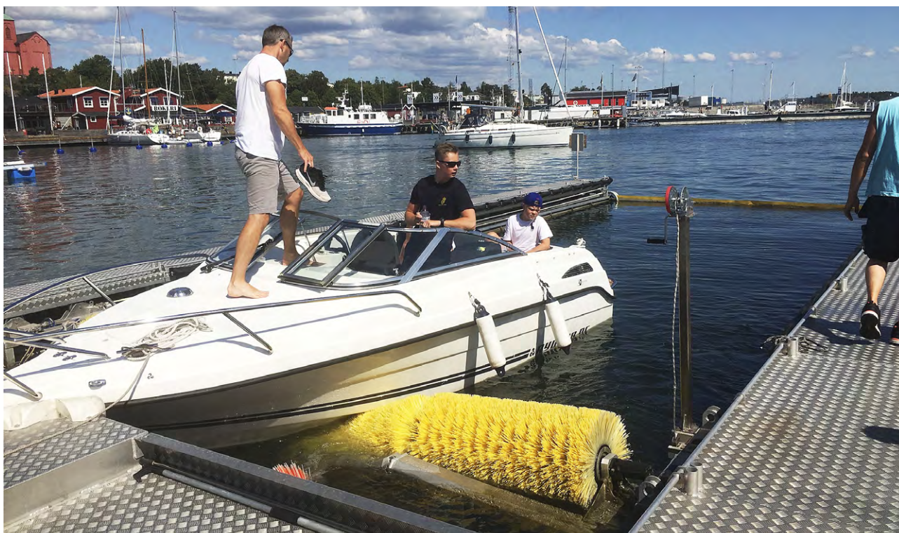
Bild 9:6 Med regelbunden tvätt av båtens botten behövs ingen biocidfärg för att förhindra påväxt. Foto: Jimmy Dominus.
