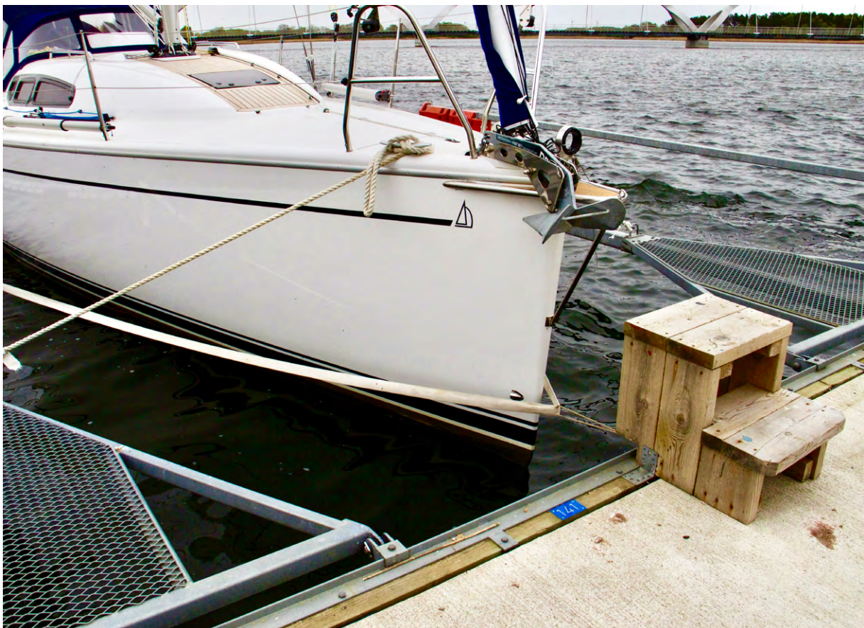
Bild 2:52 Lina/spännband mellan bommarna som tar emot innan båten tar i bryggan. Sedan kan båten ligga förtöjd nära bryggan vilket gör det enklare att stiga iland och ombord. Foto: Jonas Ekblad.
