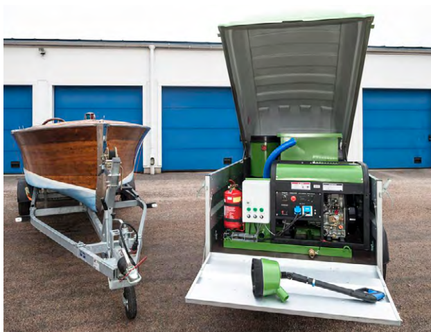
Bild 4:2 Mobil båtbottentvätt. Foto: Ekowasher AB.
