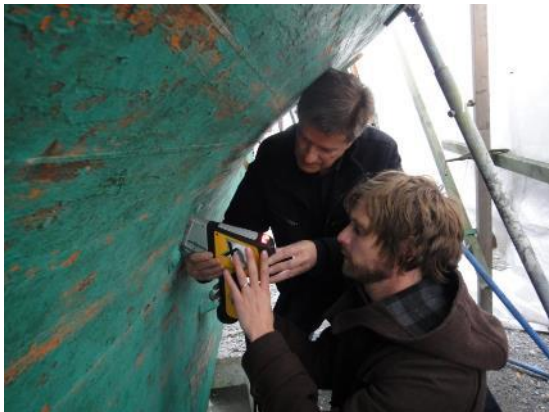
Identifiering av gamla TBT-färger med handhållet röntgeninstrument
