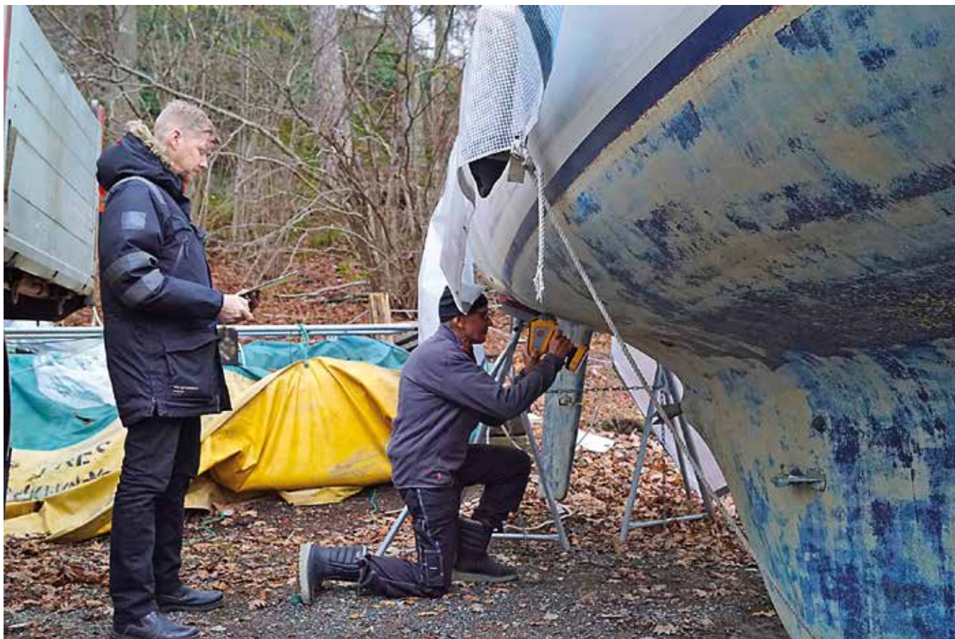
XRF-mätning på båtskrov hos Saltsjöbadens Båtklubb.
