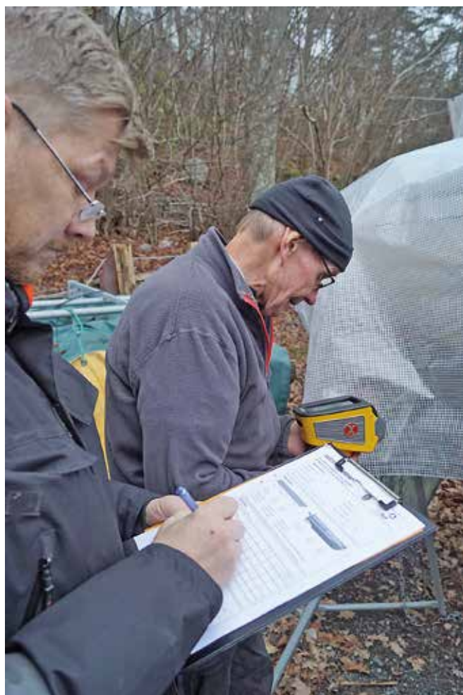
XRF-mätning på båtskrov hos Saltsjöbadens Båtklubb.
