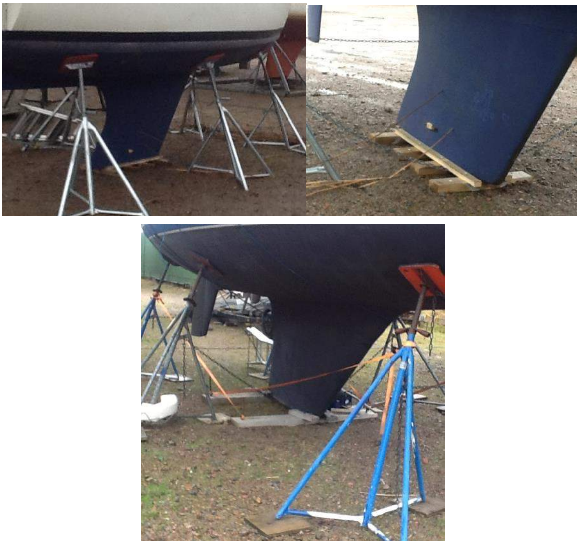
Bild: 4:10 Visar exempel på säkrade stöttor och fixerad köl
