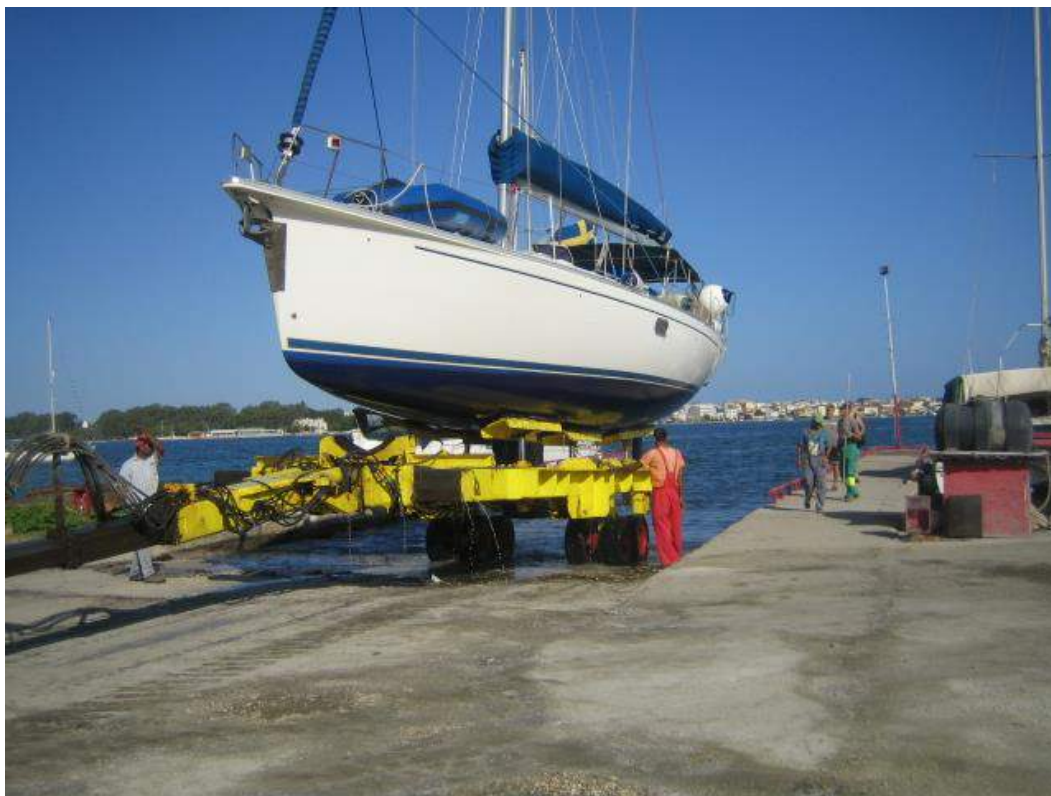
Bild. 3:12 Upptagning med hydraulvagn kopplad till traktor
